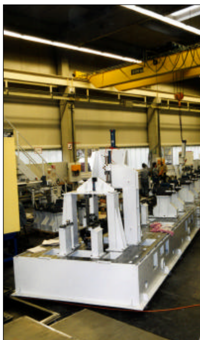
Endmontage einer Honmaschine, die bis zu 24 Meter lang sein können
